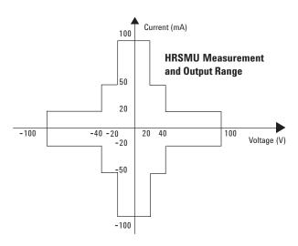
$<sup>^{2}</sup>$  100mA (Vout  $\leq$ 20V), 50mA (20V<Vout $\leq$ 40V), 20mA (40V<Vout $\leq$ 100V)
